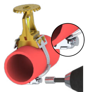
Figure 6 : Serrer jusqu'à la casse de la vis de serrage. Vitesse de serrage préconisée entre 300 et 500 tr/min max.
