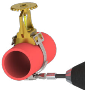
Figure 5 : Serrer le collier à l'aide d'une visseuse
