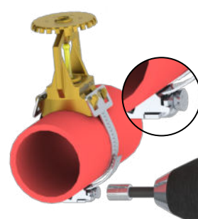
Figure 6 : Serrer jusqu'à la casse de la vis de serrage Vitesse de serrage préconisé entre 300 et 500 tr/min max.
